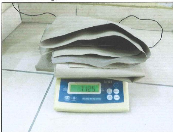
Imagen N° 22: Vista del resultado de la muestra Tomada (Lona tensada), con un resultado de 712.50 gr/m 2 .
