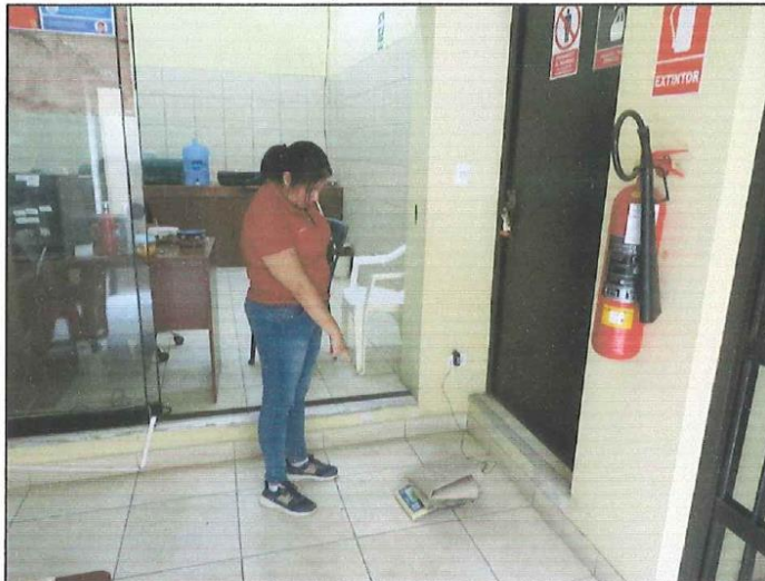
Imagen N° 21: Vista del pesado de una muestra (1.00m 2 ) de la cobertura tensada existente para determinar el gramaje.
