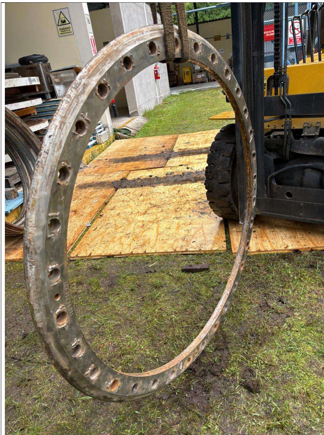
Anillo fijo o asiento de válvula 03; peso 60.00 Kg
