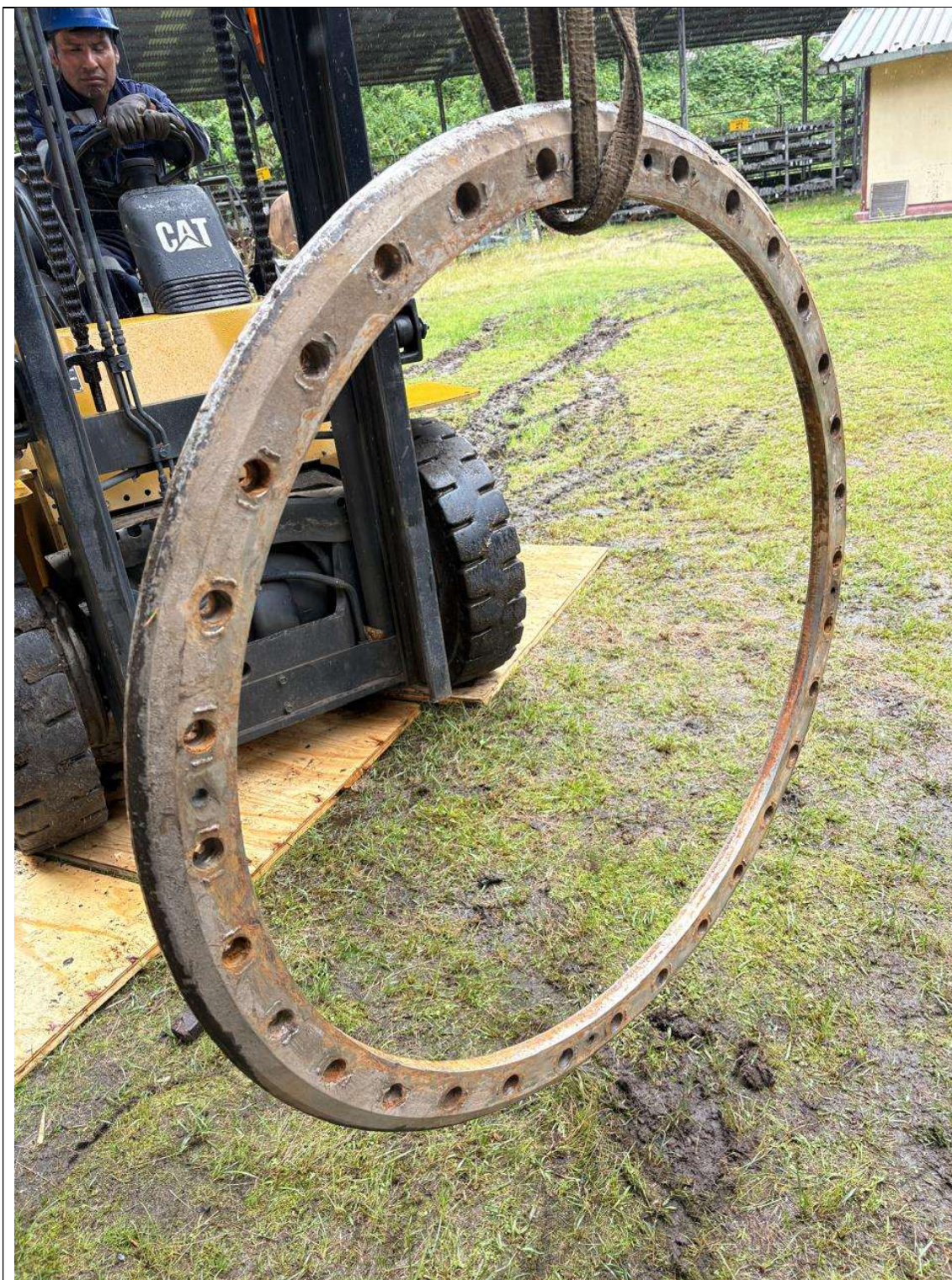
Anillo fijo o asiento de válvula 02; Peso 55.0 Kg
