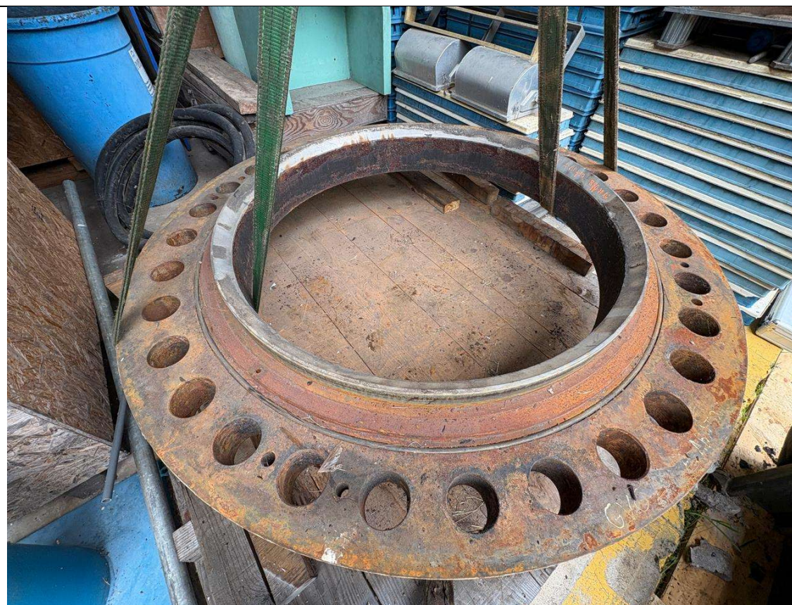
Anillo portajunta aguas abajo 01; peso 880 Kg
