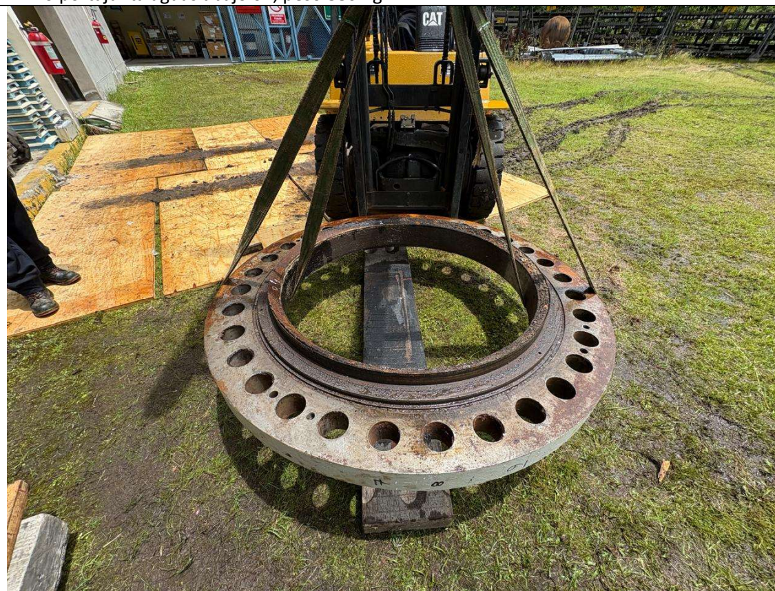
Anillo portajunta aguas abajo 02; peso 875.0 Kg
