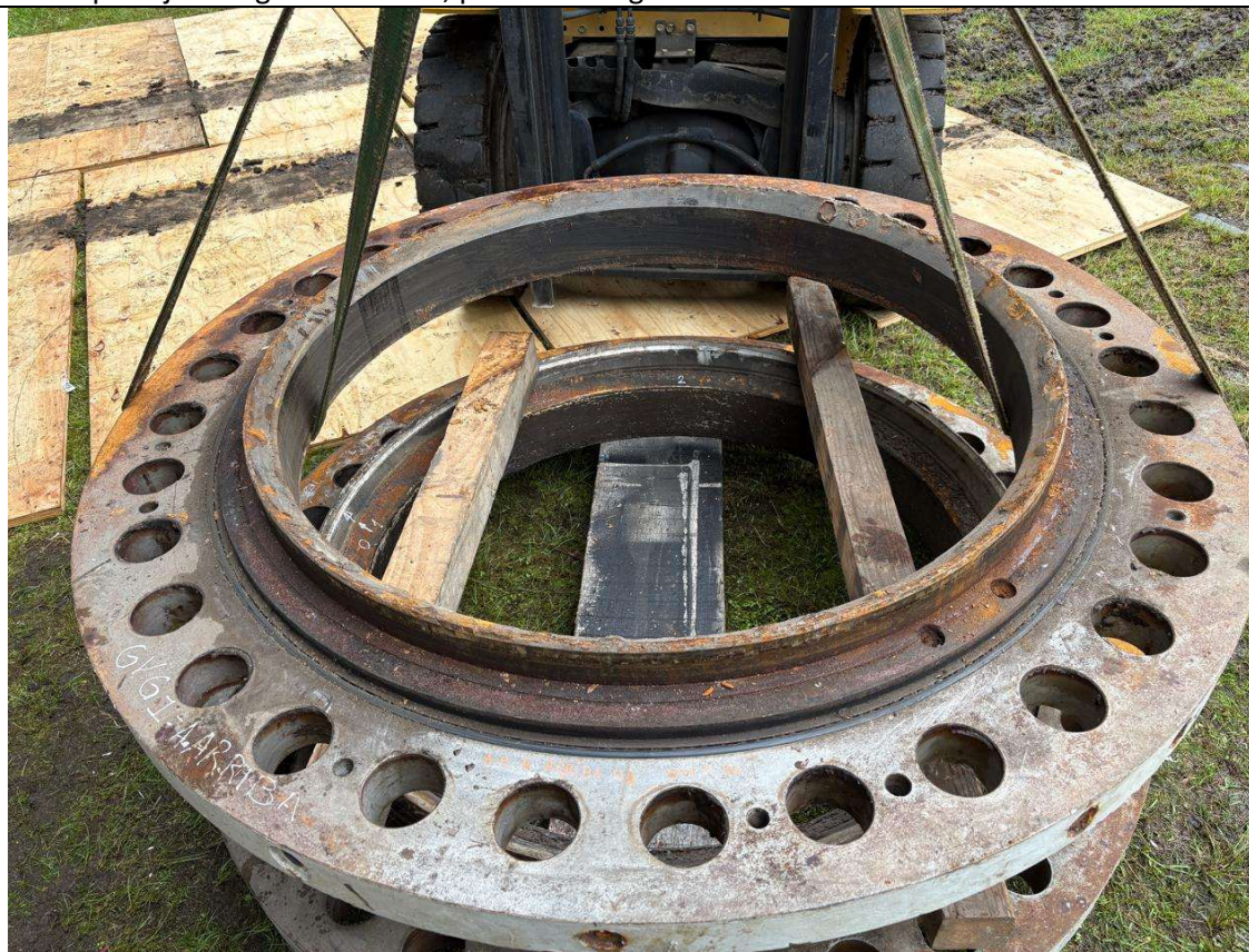
Anillo portajunta aguas arriba 02; peso 675.0 Kg
