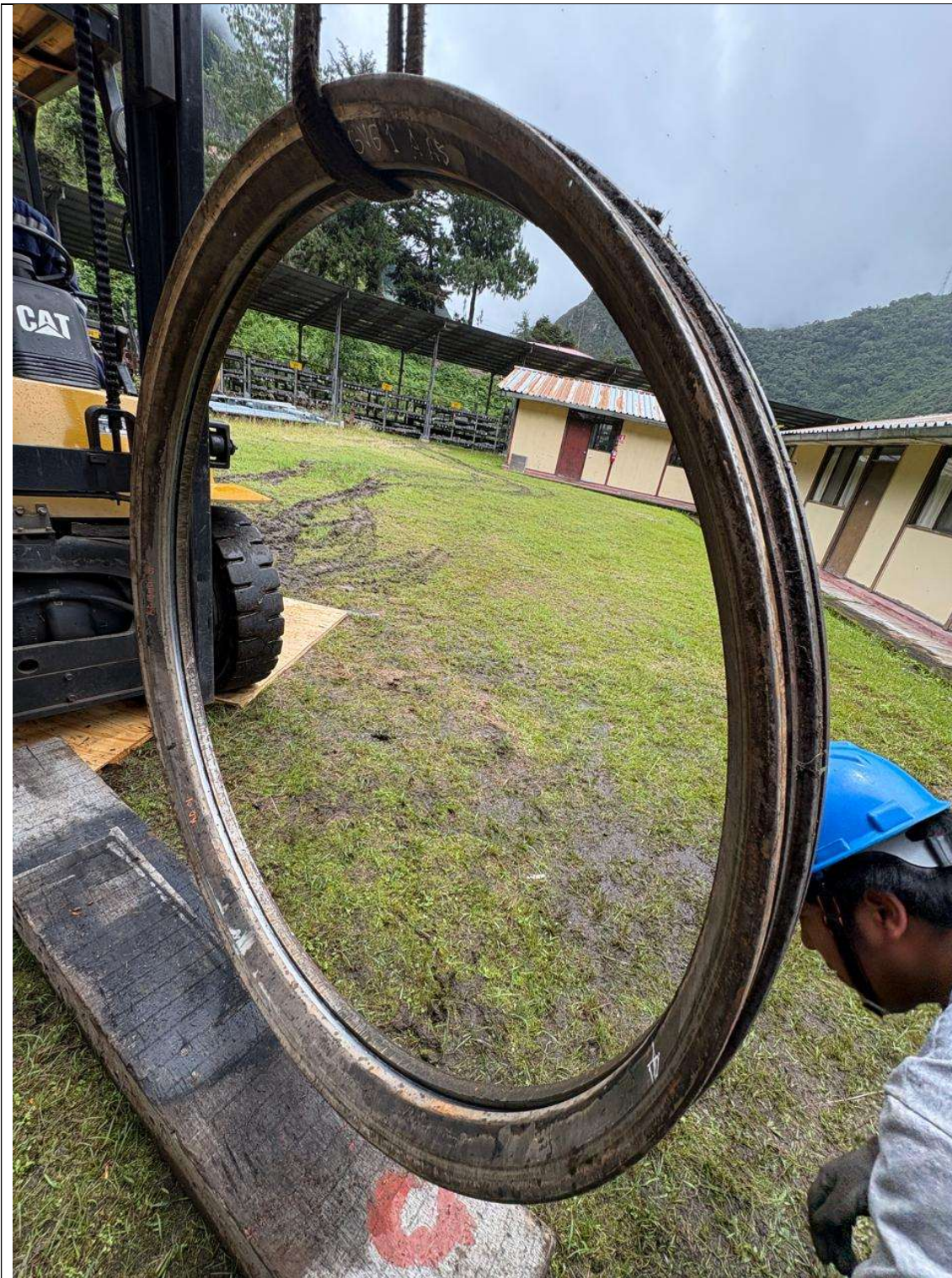
Anillo Deslizante 01; peso 105.0 Kg
