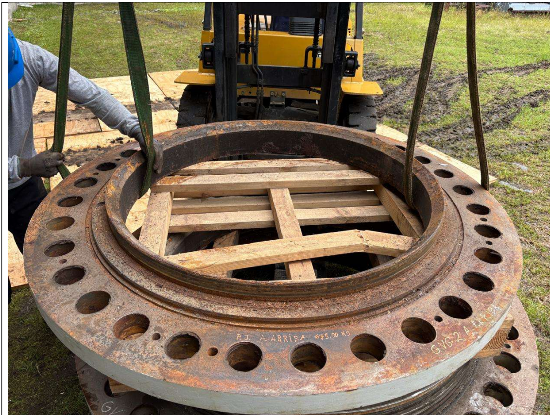
Anillo portajunta aguas arriba 01; peso 675.0 Kg
