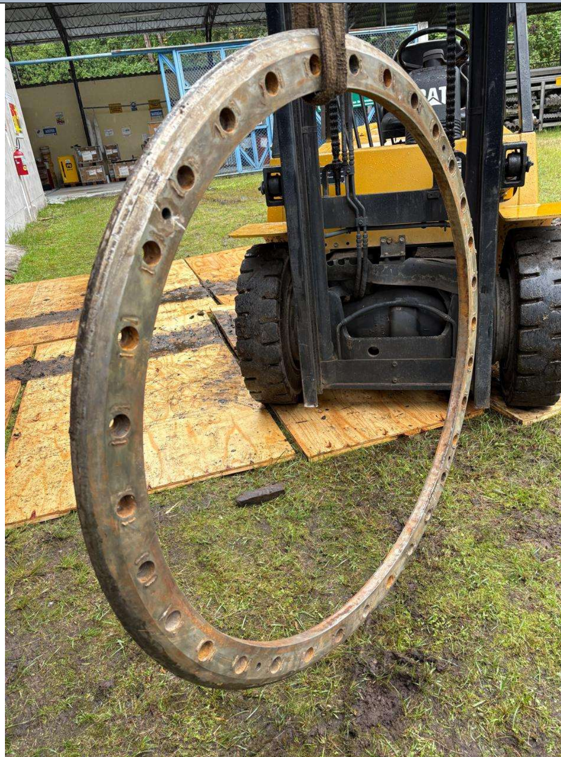
Anillo fijo o asiento de válvula 01; peso: 55 Kg
