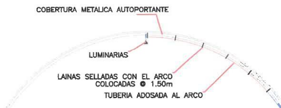
COLOCACION DE LAINAS EN EL ARCO
