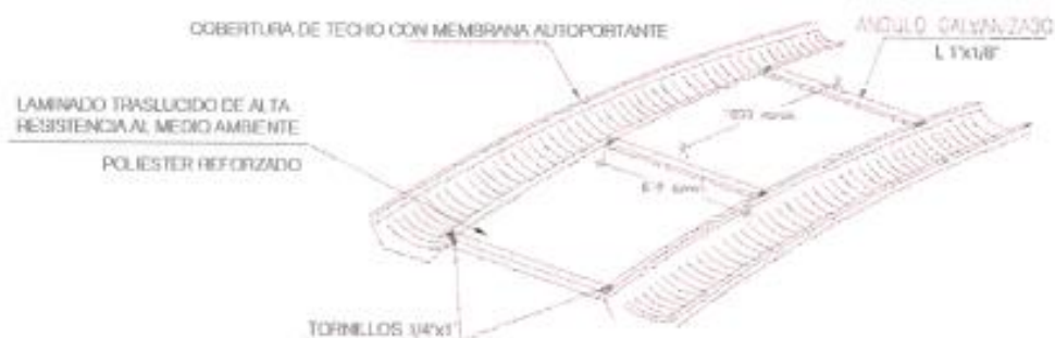
DETALLE DE COLOCACION DE TRASLUCIDOS (6% DEL ÁREA TECHADA)
