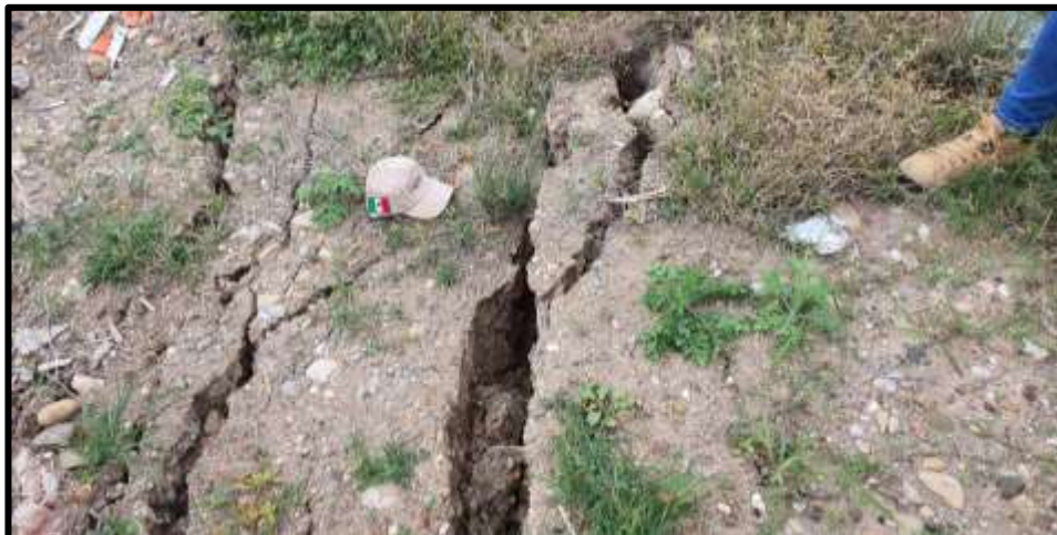
Imagen No. 03. Grietas de tensión sobre la plataforma realizada con material de cubierta
