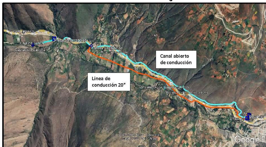
Ilustración 11: Líneas de conducción de agua cruda
