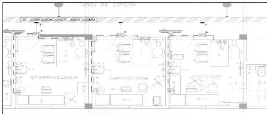
Figura 11 – Propuesta Original de salidas de data en donde las mismas ingresan por una tabiquería de la bandeja
