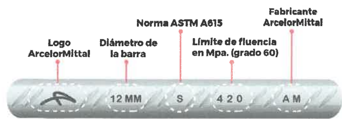
Identificación de barras en milímetros (8 mm y 12 mm)
