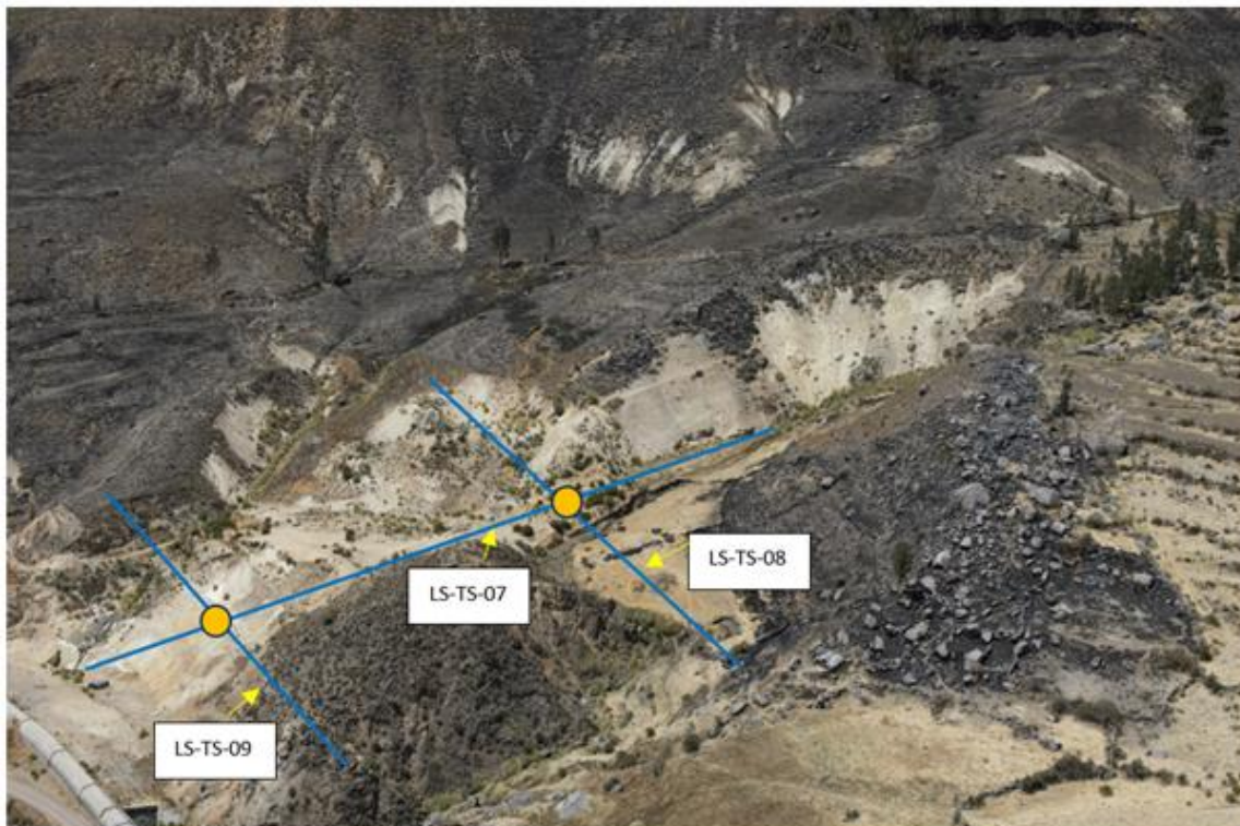
Figura 2.4.4-2 Distribución de perfiles geofísicos y perforaciones en la quebrada adyacente al portal de salida del Túnel 9.
