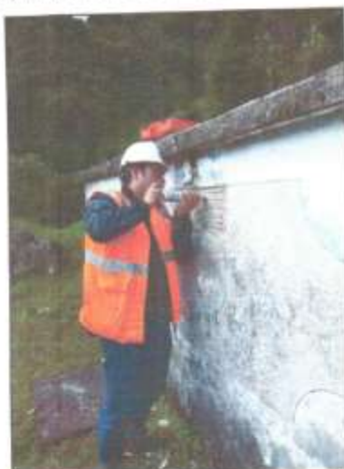
Realización del ensayo de esclerómetro.
