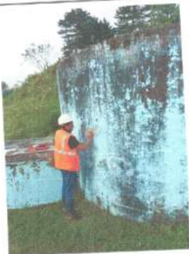
Realización del ensayo de esclerómetro.
