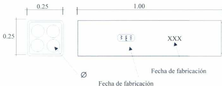
Detalles del ducto de 4 vías
