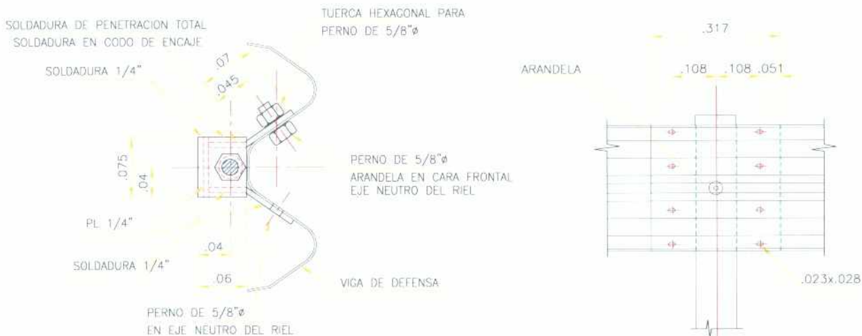
Detalle de conexiones de guardavías y accesorios
