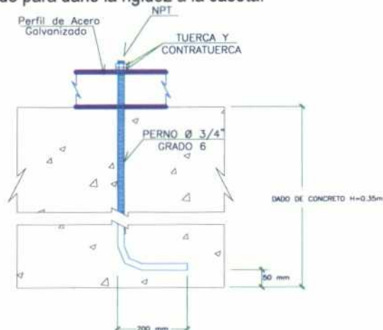
DETALLE 1: Anclaje Bastidor de Perfiles de Acero Galvanizado al Dado de C'A
