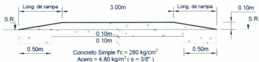
Sección de resalto del concreto
