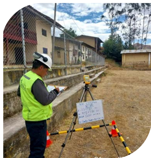
Monitoreo de radiaciones no ionizantes (RNI) en las redes de Hidrandina.
