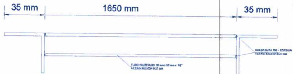
CORTE - REJILLA INOX PISO DE COCINA ESCALA: 1 / 5
