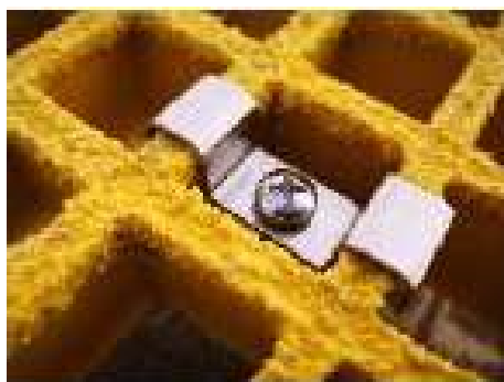
Clips de fijación tipo M, en acero INOX 304, con perno de \frac{1}{4} x 2", tuerca y arandela. Se requieren 4 unidades por m2 de grating.
