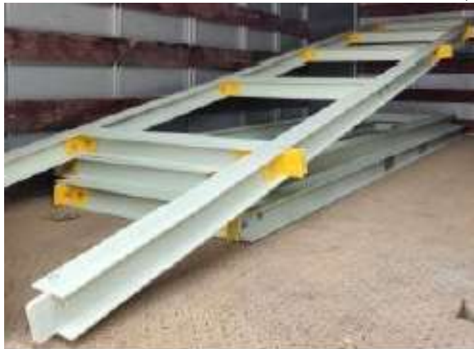
Estructura de pasarela en fibra de vidrio de 1m de ancho, como soporte de las parrillas o grating, en base a perfiles C de 4"x2"x4mm
