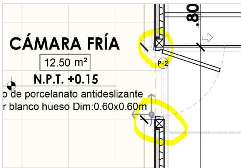
Imagen14. Imagen de la ubicación de los accesorios de PVC en “L” en la cámara fría
