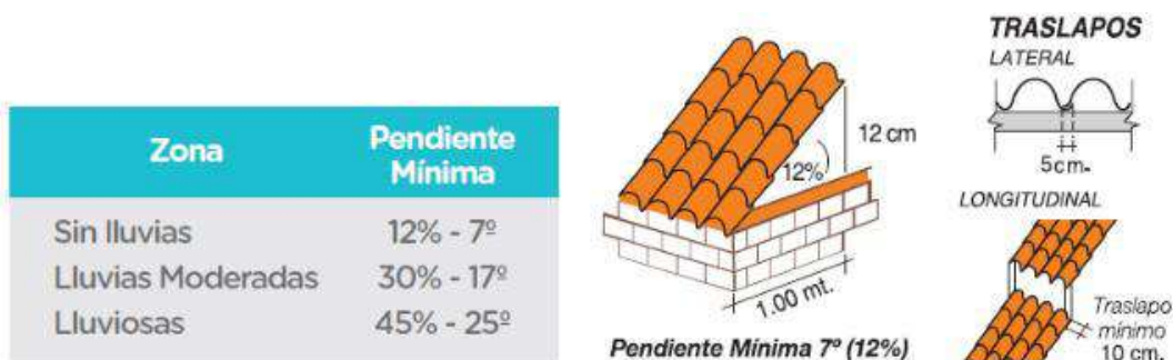
Imagen 26. Gráfico de indicaciones sobre la colocación de la plancha en pendientes.
