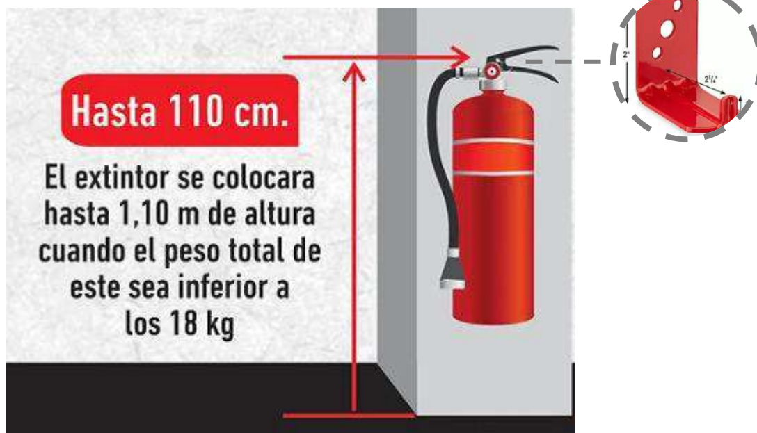
Imagen 44. Imagen indicando la altura a ser fijado el extintor y el tipo de gancho.
