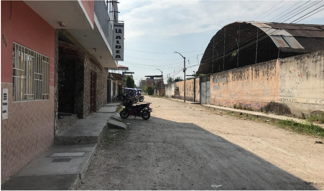
Ilustración 74: Progresiva: 0+076 JR. MIRAFLORES – Cuadra 04 Calle en terreno natural (entre el Jr. Huandoy y Jr. Huascarán). Viviendas de hasta 4 pisos, cuentan con veredas irregulares deterioradas a ambos lados de la vía.
