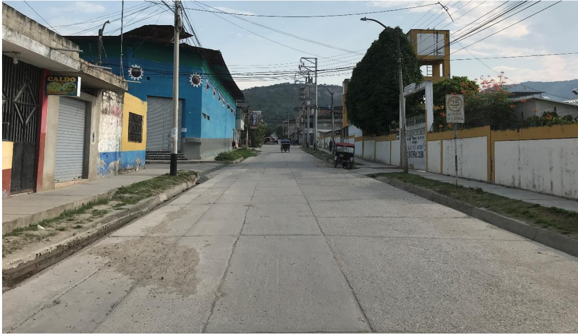
Ilustración 36: Progresiva: 0+075 JR. COMERCIO – Cuadra 06 Calle con pavimento existentes (entre la Av. Héroes del Cenepa y Jr. Sargento Lores) en mal estado. Viviendas de uno o dos pisos, cuentan con veredas irregulares deterioradas a ambos lados de la vía.
