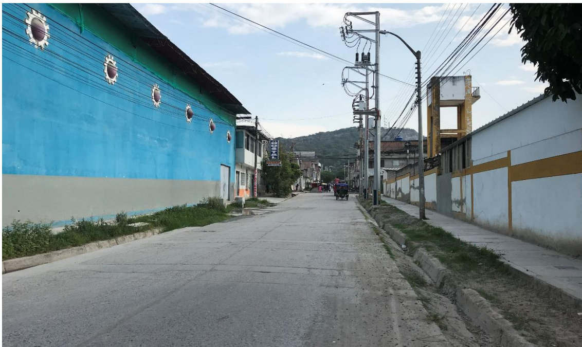
Ilustración 37: Progresiva: 0+050 JR. COMERCIO – Cuadra 07 Calle con pavimento existentes (entre la Av. Héroes del Cenepa y Jr. Sargento Lores) en mal estado. Viviendas de uno o dos pisos, cuentan con veredas irregulares deterioradas a ambos lados de la vía.
