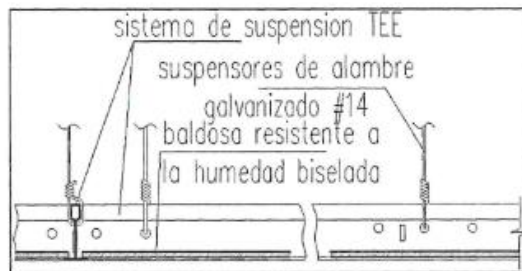
Detalle de sistema de soporte N° 02
