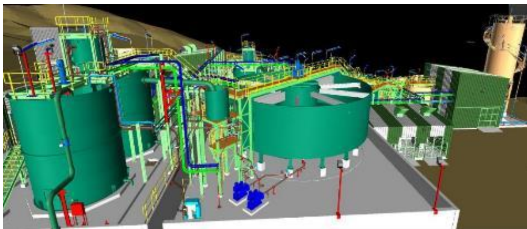
Ilustración 2. Vista 3D del sistema de automatización, tuberías válvulas y motores
