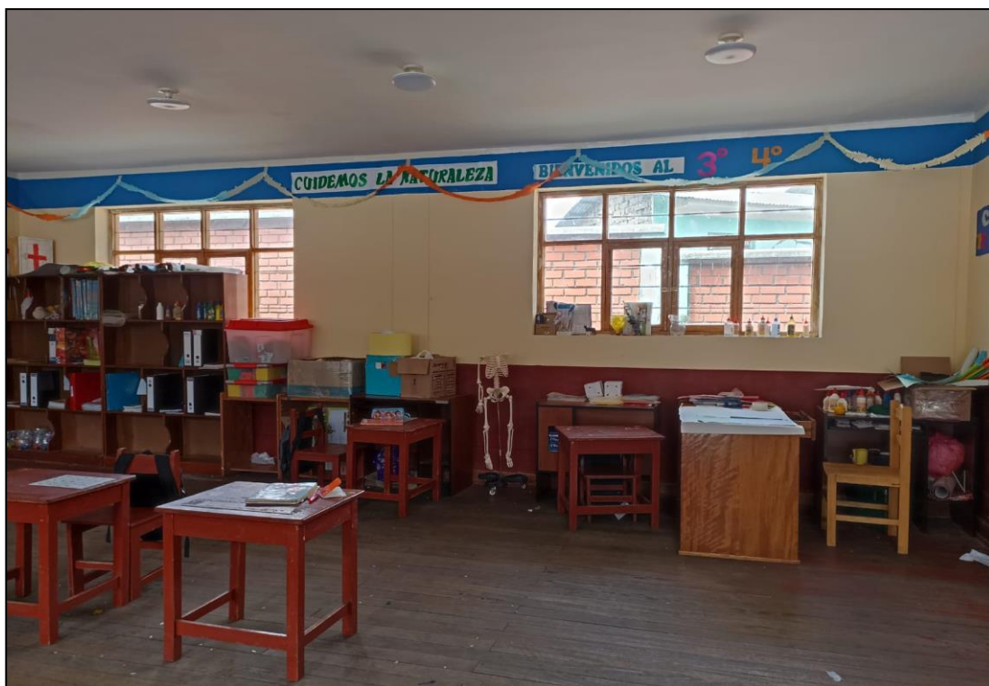
Imagen N°07: Al interior del aula 1, piso machihembrado, muros tarrajeados de ladrillo, falso cielo raso con yeso.
