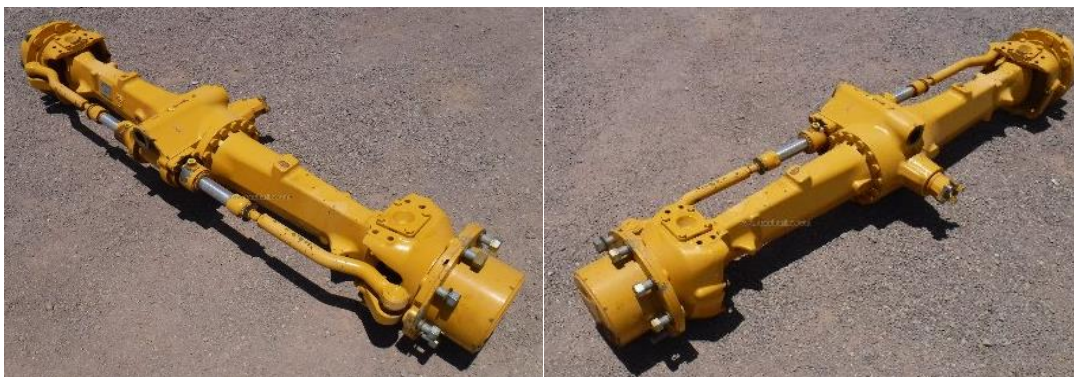
Eje Delantero de una Retroexcavadora
