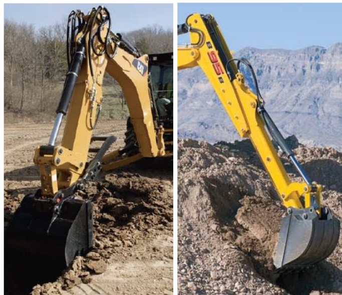
Brazo Normal y Brazo Extensible del retro excavador
