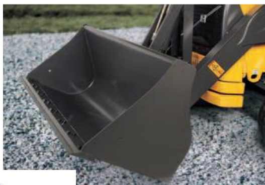
Formas diversas de la cuchara del cargador con segmentos
