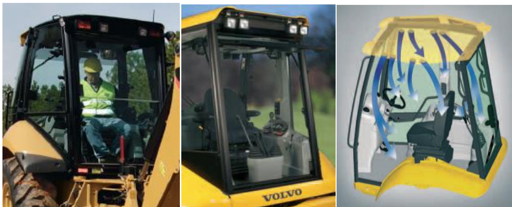
Cabina de retroexcavadora cargador y Esquema de circulación del aire acondicionado en la cabina
