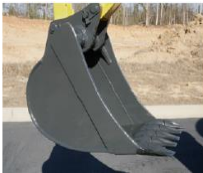
Diversas formas del cucharón del excavador y de sus dientes
