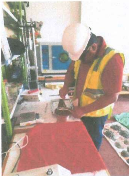
GRAFICO N°01: ENSAYO PESO ESPECIFICO DEL AGREGADO FINO
