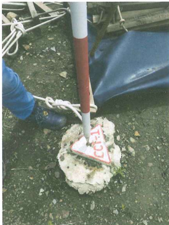
Foto N°07: se aprecia el punto de control cct-01 monumentado
