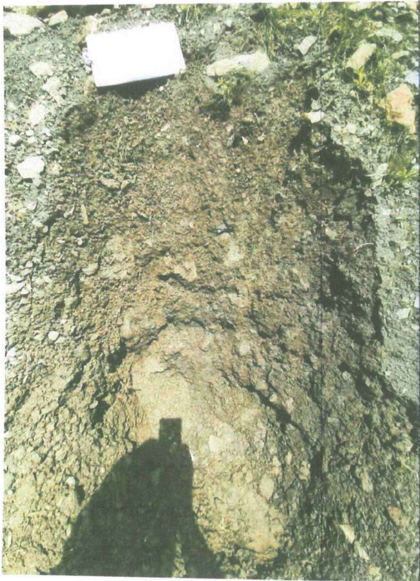
Gráfico N°12: Perfil Estratigráfico encontrado.
