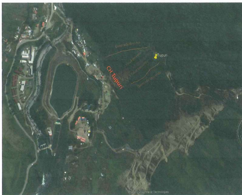
Figura 10. Ubicación de la zanja de excavación para la tubería forzada, la cámara de carga y la casa de máquinas.
