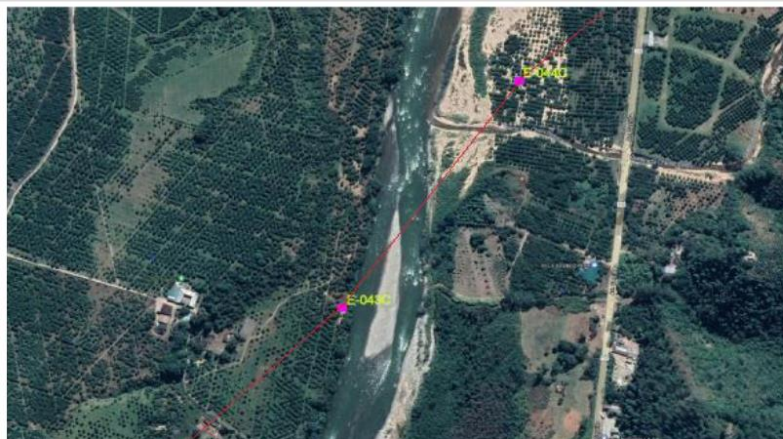
Vista del tramo E43-E44, que, en el punto más bajo del vano, no cumple con las DMS, así como la E43 se encuentra a una distancia aprox. 07 m del borde del Río Chanchamayo.
