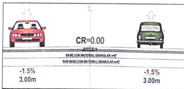
DETALLE DE PAVIMENTO ARTICULADO – ADOQUIN DE C° DE 20X10X6CM.
