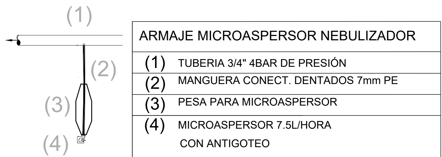
DETALLE DE MICROASPERSOR NEBULIZADOR ESC. 1/25
