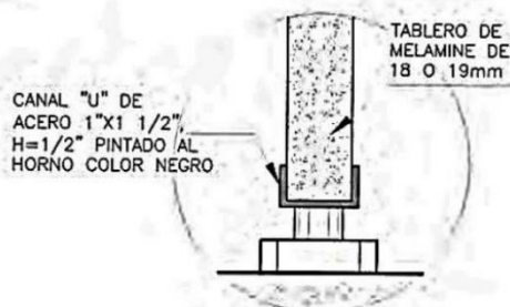
DETALLE C REGATÓN ESC: 1/2
