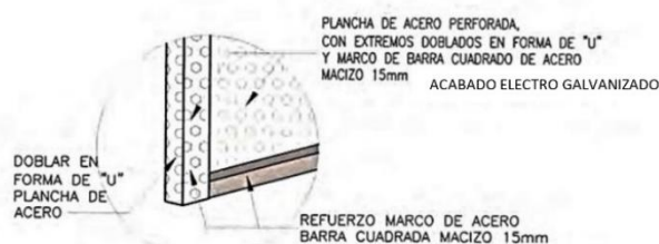
DETALLE B DOBLEZ ESC: 1/5
