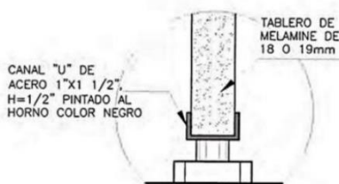
DETALLE C REGATÓN ESC: 1/2
