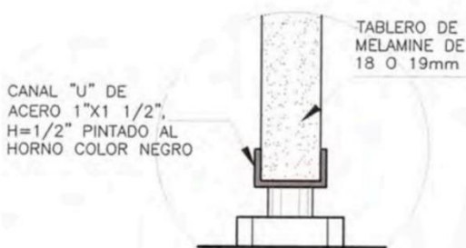
DETALLE C REGATÓN ESC: 1/2
