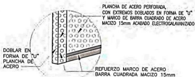
DETALLE B DOBLEZ ESC: 1/5
