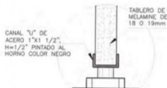
DETALLE C REGATÓN ESC: 1/2
