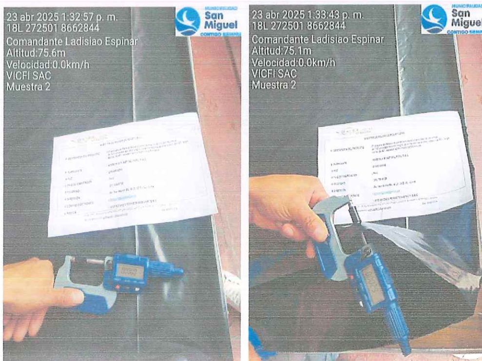
Figura N°61. Detalle de la evaluación del espesor de la sub-muestra 2 presentada por la Empresa: INVERSIONES FERRETERAS VICFI S.A.C
