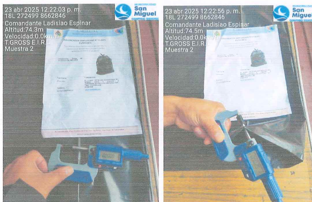
Figura N°55. Detalle de la evaluación del espesor de la sub- muestra 2 presentada por la Empresa: T. GROSS E.I.R.L.
