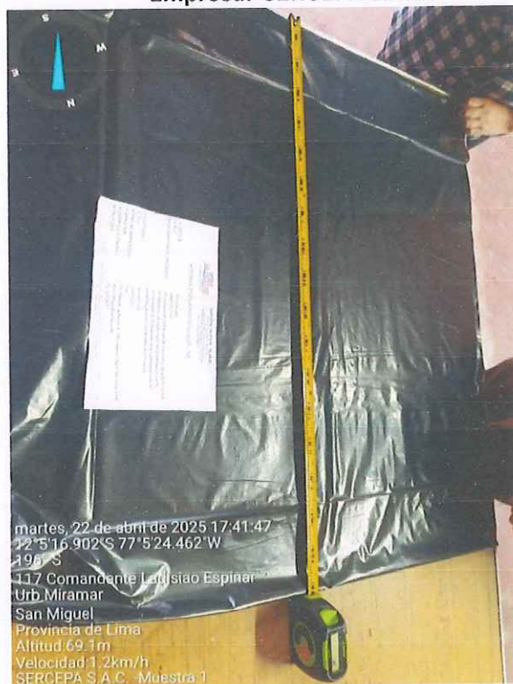
Figura N°52. Detalle de la evaluación del ancho de la Submuestra 1 presentada por la Empresa: SERCEPA S.A.C.
