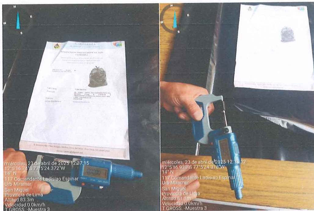
Figura N°60. Detalle de la evaluación del espesor de la sub- muestra 3 presentada por la Empresa: T. GROSS E.I.R.L.
