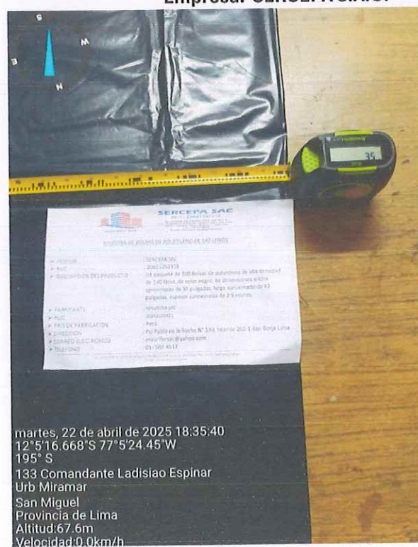
Figura N°57. Detalle de la evaluación del ancho de la Submuestra 3 presentada por la Empresa: SERCEPA S.A.C.
