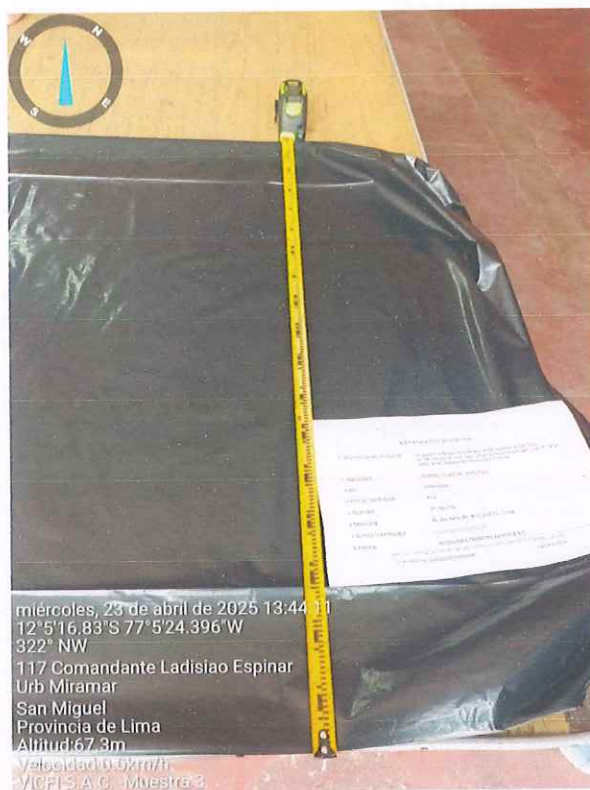
Figura N°44. Evaluación del ancho de la Sub-muestra 3 presentada por la Empresa: INVERSIONES FERRETERAS VICFI S.A.C.
