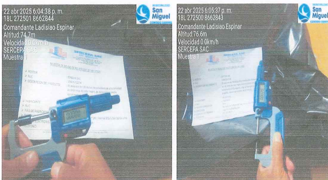
Figura N°63. Detalle de la evaluación del espesor de la sub-muestra 1 presentada por la Empresa: SERCEPA S.A.C.
