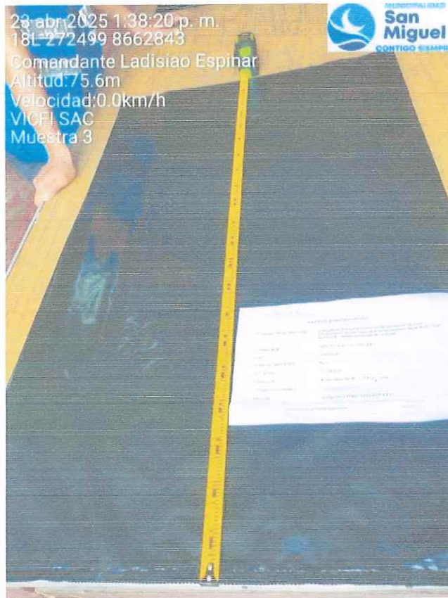
Figura N°35. Evaluación de longitud de la Sub-muestra 3 presentada por la Empresa: INVERSIONES FERRETERAS VICFI S.A.C.
