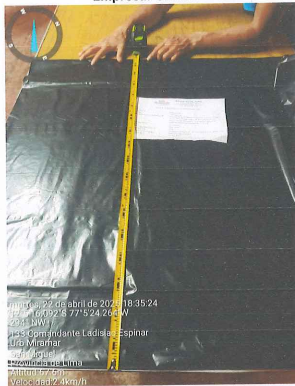
Figura N°57. Detalle de la evaluación del ancho de la Submuestra 3 presentada por la Empresa: SERCEPA S.A.C.
