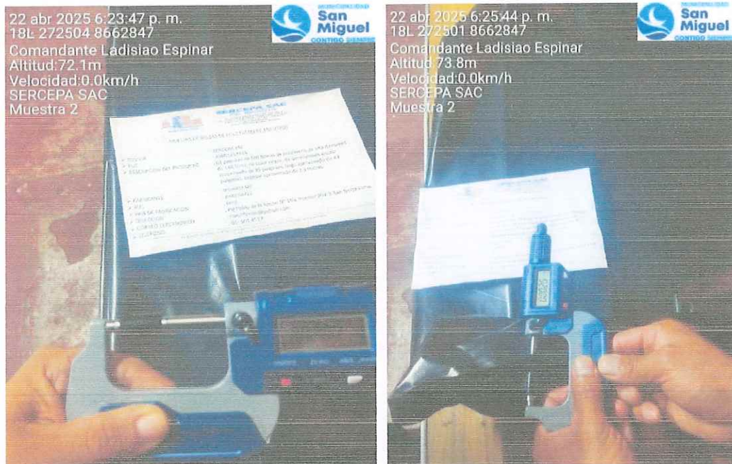
Figura N°65. Detalle de la evaluación del espesor de la sub-muestra 3 presentada por la Empresa: SERCEPA S.A.C.
