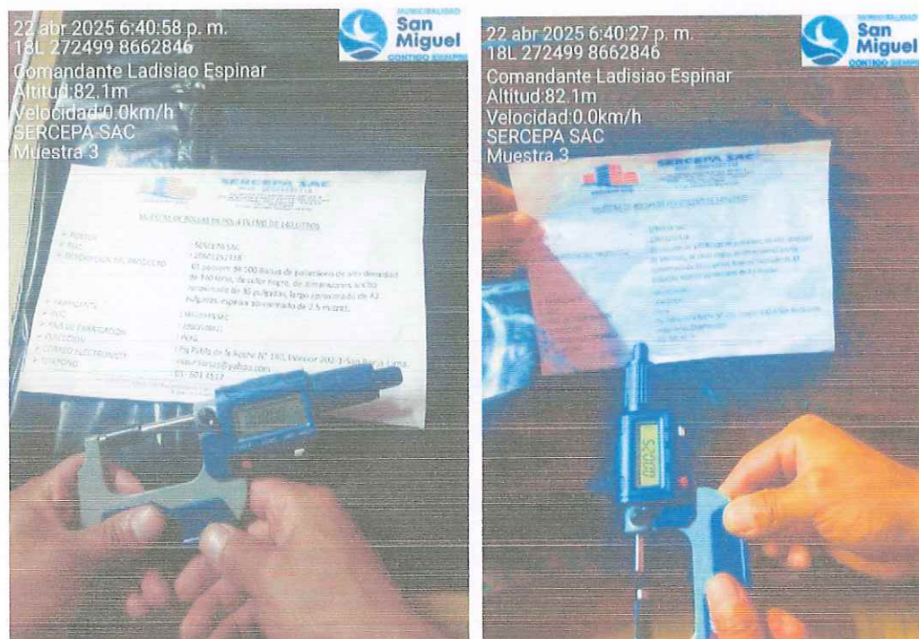
Figura N°65. Detalle de la evaluación del espesor de la sub-muestra 3 presentada por la Empresa: SERCEPA S.A.C.
