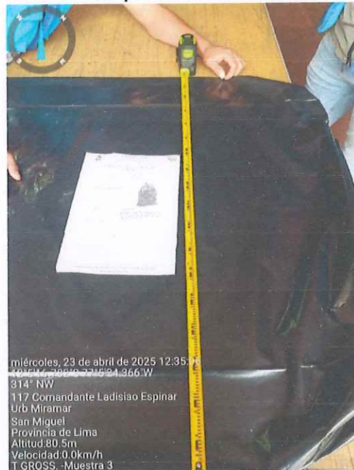
Figura N°32. Detalle de la evaluación del ancho de la Submuestra- 3 presentada por la Empresa: T. GROSS E.I.R.L.
