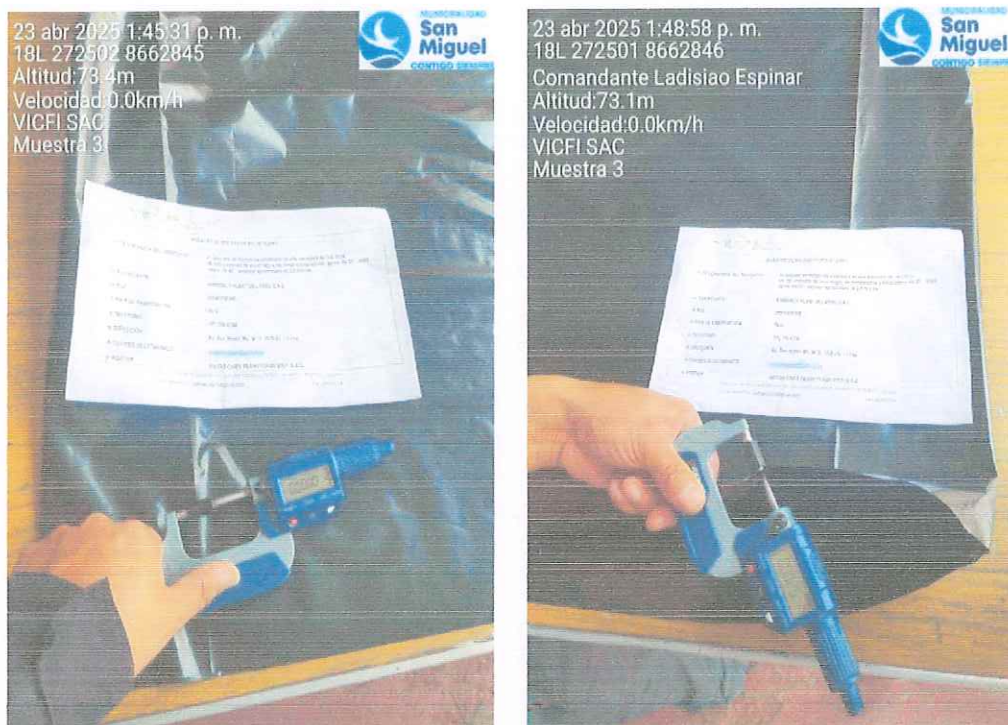
Figura N°62. Detalle de la evaluación del espesor de la sub-muestra 3 presentada por la Empresa: INVERSIONES FERRETERAS VICFI S.A.C
