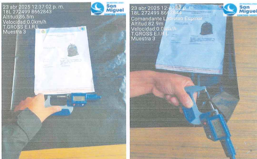
Figura N°56. Detalle de la evaluación del espesor de la sub- muestra 3 presentada por la Empresa: T. GROSS E.I.R.L.
