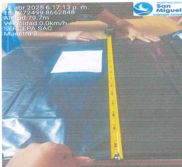
Figura N°51. Detalle de la evaluación del ancho de la Sub-muestra 2 presentada por la Empresa: SERCEPA S.A.C.
