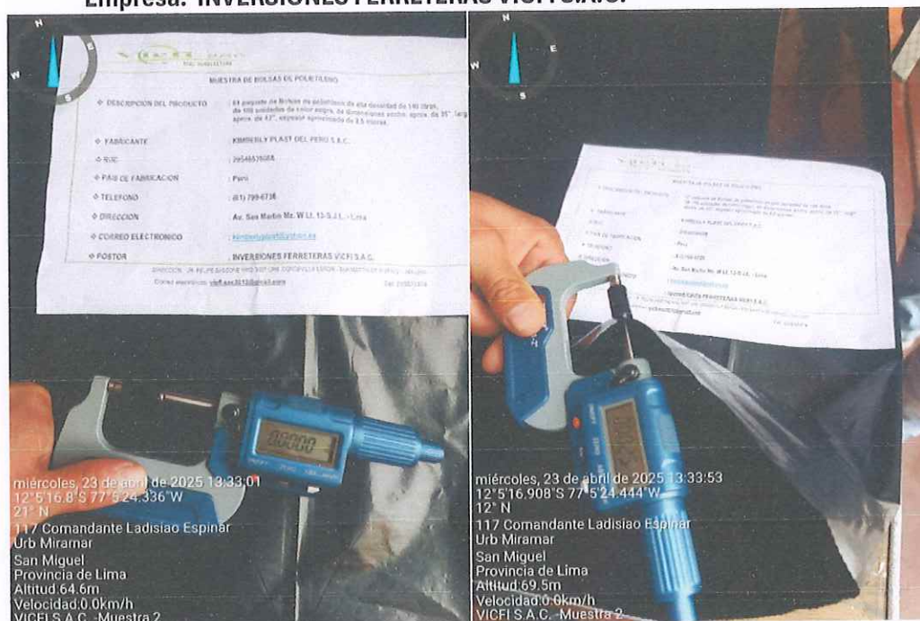
Figura N°63. Detalle de la evaluación del espesor de la submuestra 3 presentada por la Empresa: INVERSIONES FERRETERAS VICFI S.A.C.
