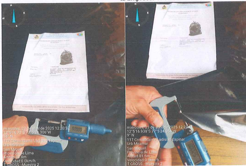
Figura N°59. Detalle de la evaluación del espesor de la sub- muestra 2 presentada por la Empresa: T. GROSS E.I.R.L.
