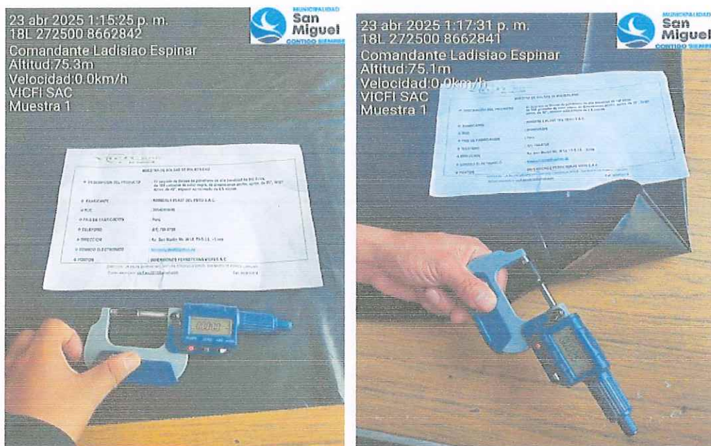
Figura N°61. Detalle de la evaluación del espesor de la sub-muestra 2 presentada por la Empresa: INVERSIONES FERRETERAS VICFI S.A.C
