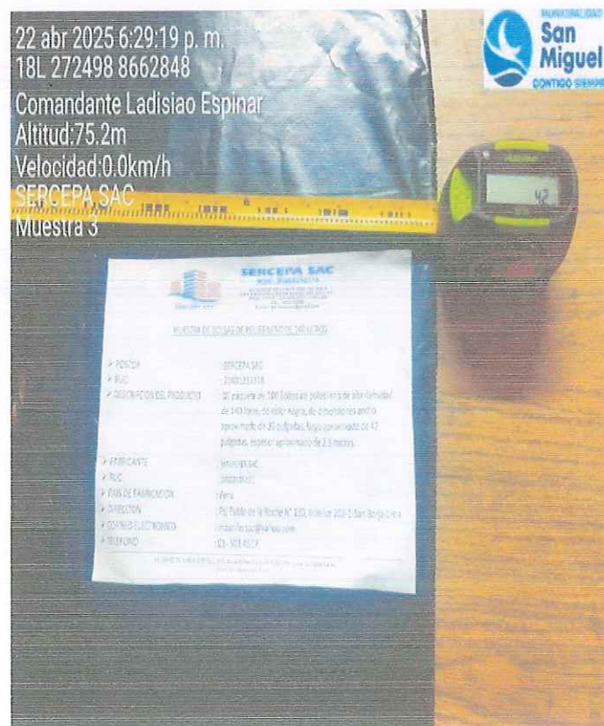
Figura N°47. Detalle de la evaluación de longitud de la Sub-muestra 3 presentada por la Empresa: SERCEPA S.A.C.
