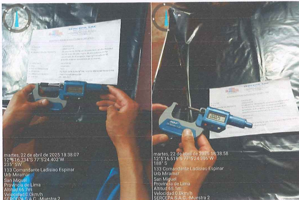
Figura N°65. Detalle de la evaluación del espesor de la submuestra 2 presentada por la Empresa: SERCEPA S.A.C.
