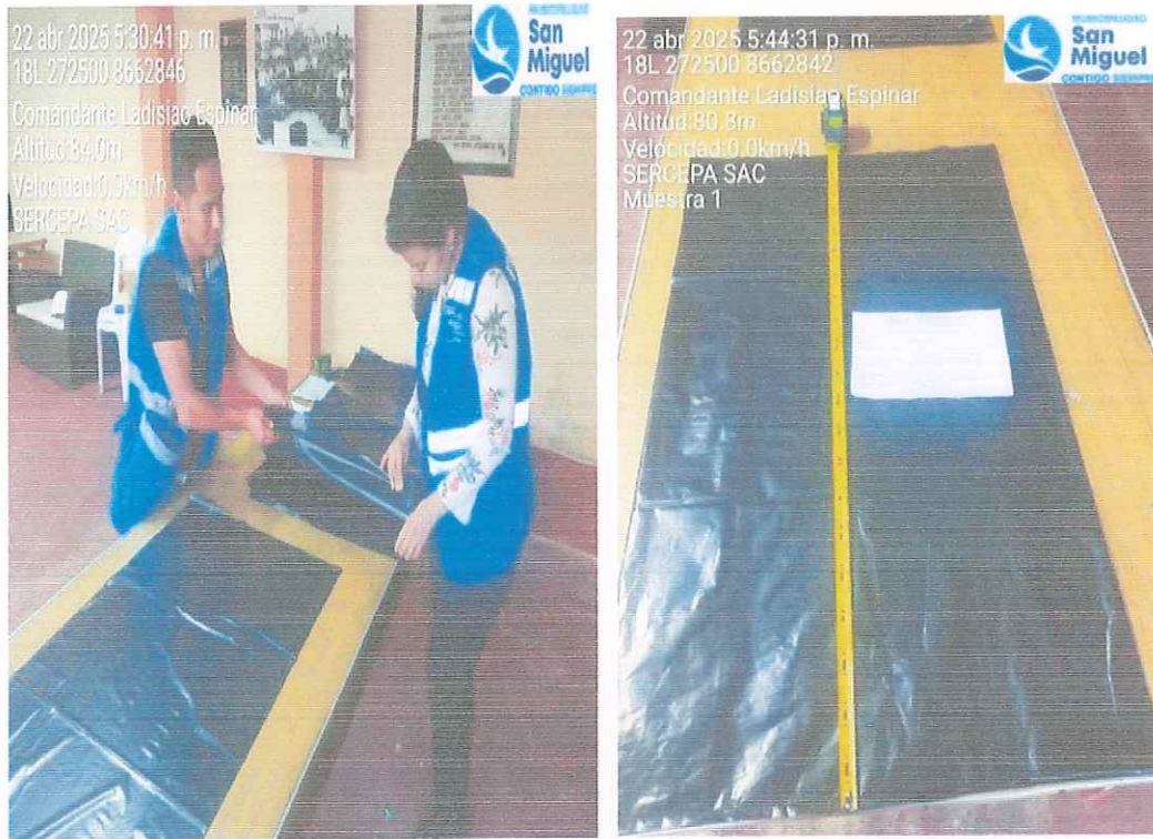
Figura N°42. Conteo, elección de 3 Submuestras y evaluación de longitud de la Sub-muestra 1 presentada por la Empresa: SERCEPA S.A.C.
