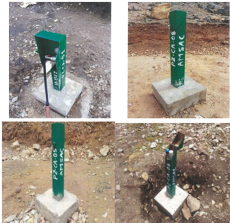
Figura 5: Modelo de piezómetro instalados
