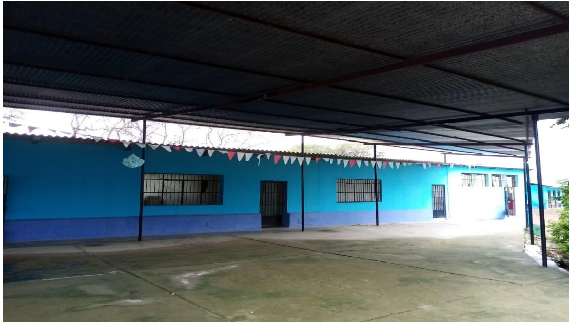
IMAGEN N° 10: El boque N° 02, está conformado por diferentes ambientes, los cuales son usados para dirección, almacén, cocina y otros, tiene más de 15 años de antigüedad, cumpliendo ya con su vida útil está construido de material noble y rustico de adobe, la cobertura es de calamina, el piso este compuesto por cemento pulido, el cual se encuentra en mal estado de conservación. Cuenta con ventanas latas y bajas de fierro con vidrio crudo. Dichos ambientes no cumplen con los parámetros de construcción de locales escolares de nivel primario según la norma de educación.
