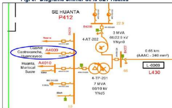
Fig. 8. Diagrama Unifilar de la SET Huanta
