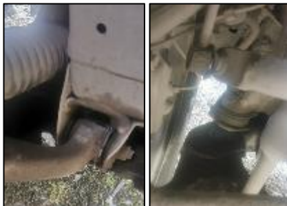
Se evidencia las bocinas de trapezio y terminales dañados.
