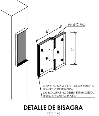
DETALLE DE BISAGRA ESC. 1:2
