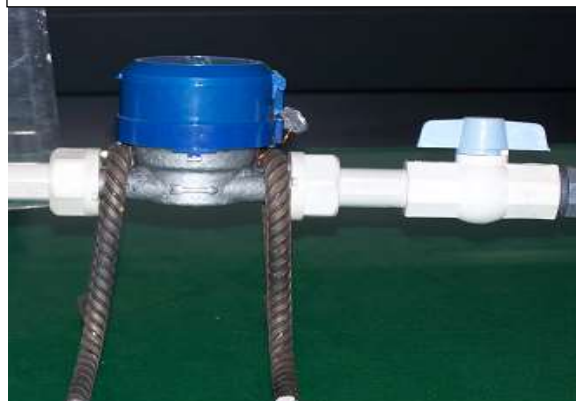
Figura N.º 02: Colocación de los anclajes
