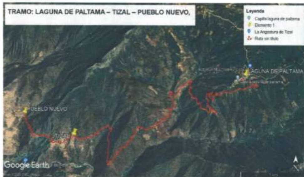
FIGURA N° 01.- Se muestra el punto inicial y final del tramo a intervenir que es Laguna De Paltama – Tizal – Pueblo Nuevo, donde se van a ejecutar los trabajos de eliminación de derrumbes, reconfiguración de plataforma; Con coordenadas inicial E=652464.00 m, N=9381133.00 m Laguna De Paltama y Final E=647759.00 m, N=9380660.00 m Pueblo Nuevo con una longitud de 11.10 KM aproximadamente.
