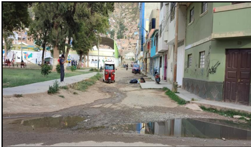
Foto N° 02: Vista del Jr. Norberto Aro Cuadra 1 carente de pistas, cunetas y presenta baches que dificultad el tránsito vehicular -final.
