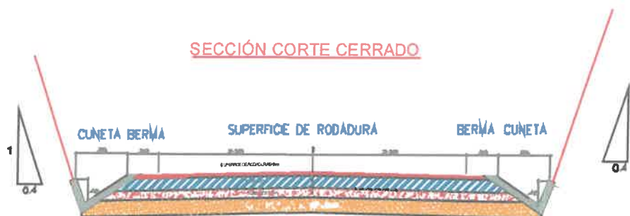
Imagen 10: Sección típica de la vía – Sin mejoramiento
