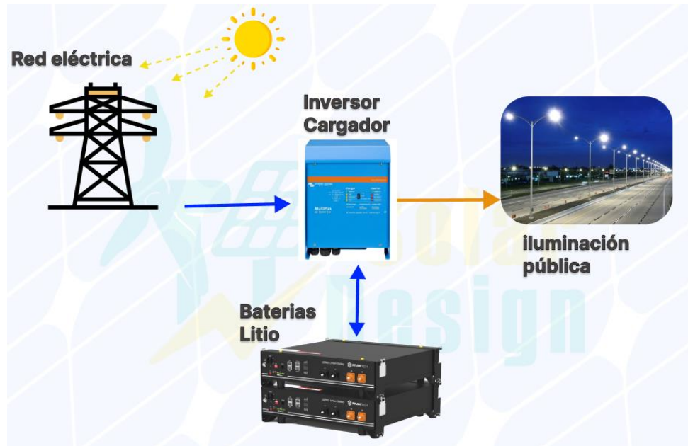
Diagrama de interconexión al tablero que controla la iluminación pública.
