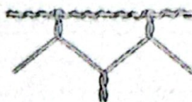
Detalle de la unión mecánica de la malla con el alambre de borde
