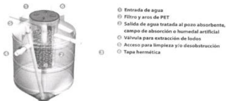
Ilustración 5: Esquema del biodigestor autolimpiable
