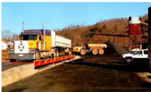
FIG. 3: DETALLE D LAS GUARDAS LATERALES DE LA BALANZA
