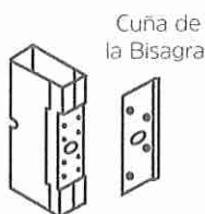
Bisagra de acero de 10 GA (3,5 mm) Bisagra de 4.10"
