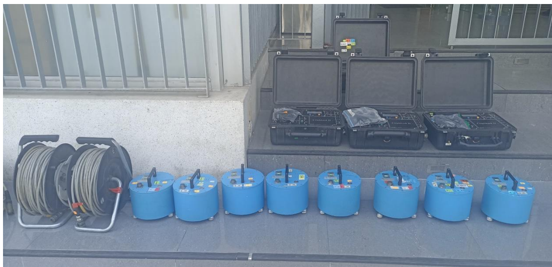
Figura 2.- Equipos utilizados para el registro de señales de vibración ambiental: registradores tipo City Shark II y sensores de tres componentes (NS, EO y V) tipo Lennartz.
