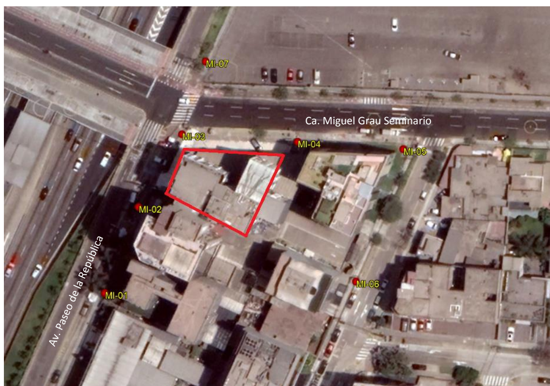
Figura 5.- Ubicación de los puntos de adquisición de registros de vibración ambiental en campo libre. El polígono rojo indica la ubicación del edificio de la sede central del MIDIS.
