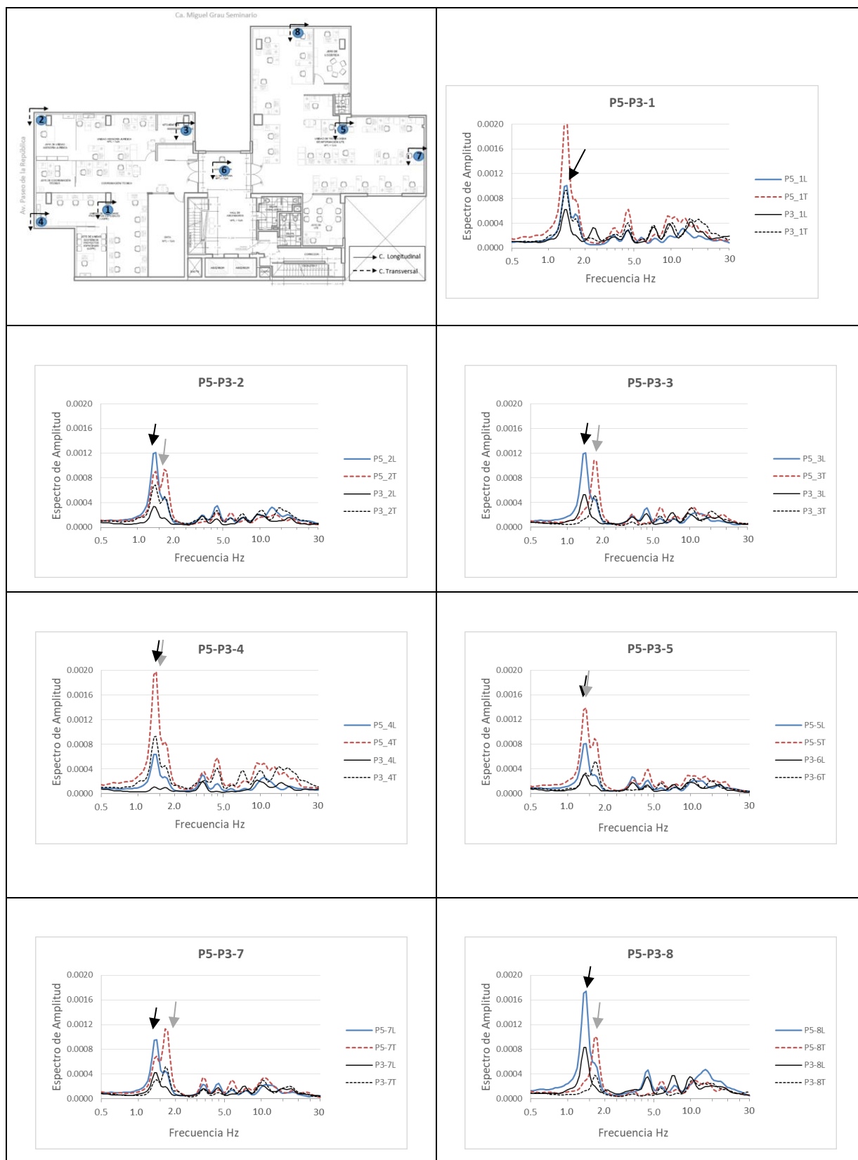
Figura 9.- Ubicación de los sensores en el piso 5 y el piso 3 del bloque B1 y B2, además de los Espectros de amplitud obtenidos para cada punto. Las curvas continuas, corresponden a su componente Longitudinal (N) y la discontinua, a su componente Transversal.
