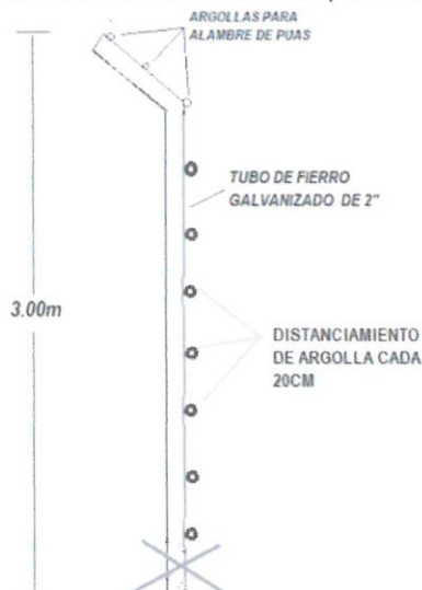
PARANTE DE FIERRO GALBANIZADO CIRCULAR DE 2" X 2mm (CORDINAR CON EL AREA USUARIA)
