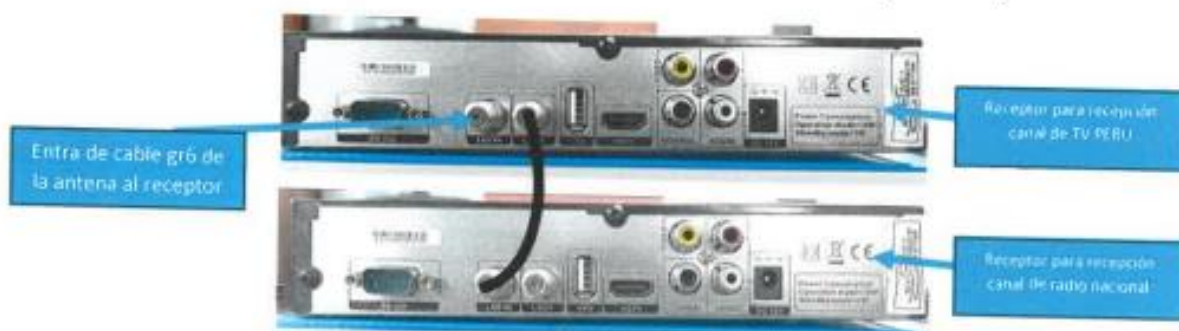
Figura N° 9: Vista de la instalación en cascada de 02 receptores para radio y televisión.
