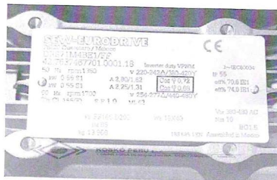
IDENTIFICACION DE UN MOTOR
