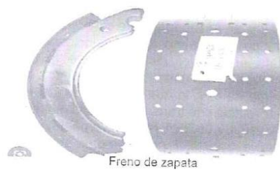
Freno de zapata
