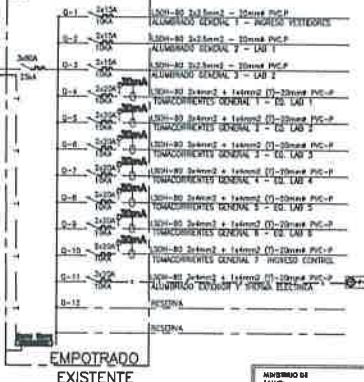
DIAGRAMA UNIFILAR TABLERO DE DISTRIBUCION 30 POLOS
