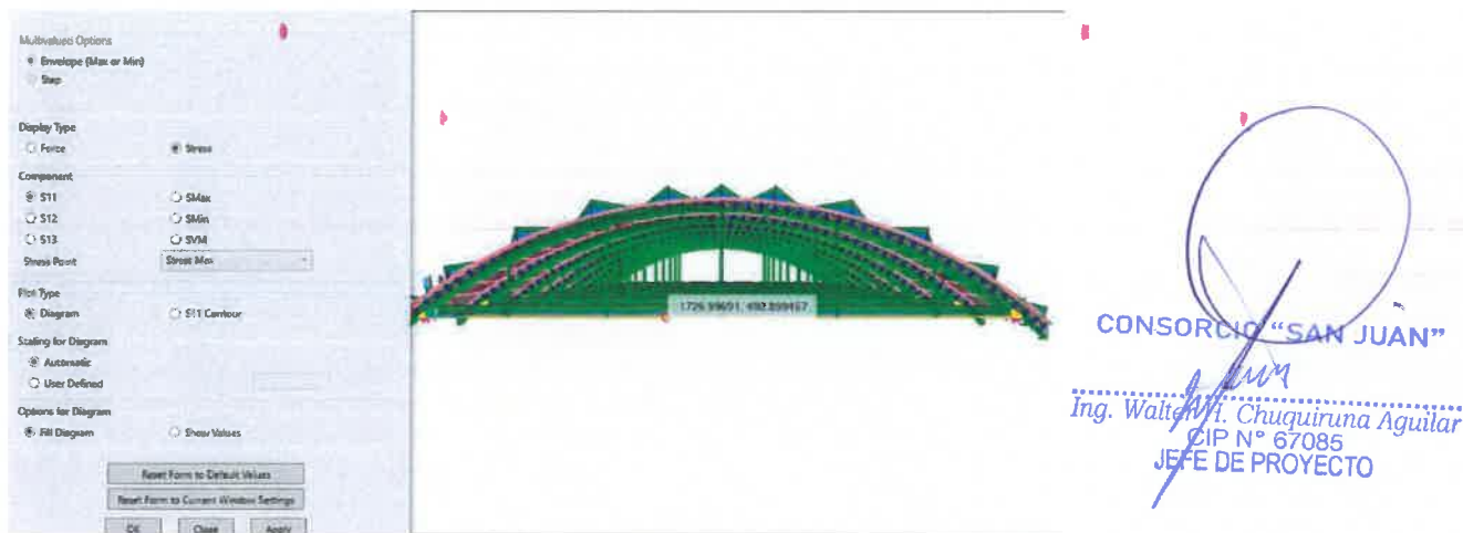
Fig. 43. Diagrama de esfuerzo axial S11 para envoltente de combinaciones de acero.
