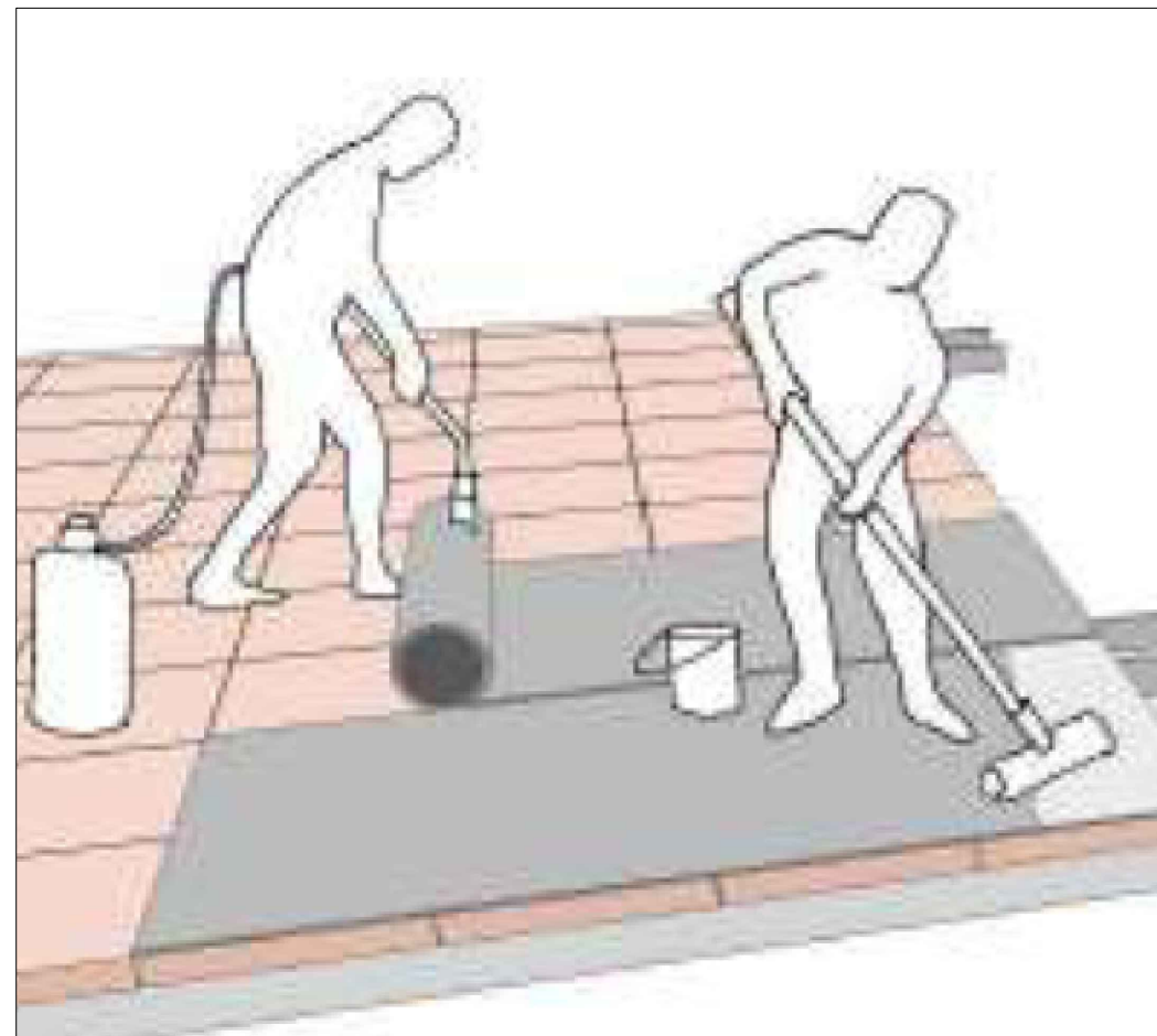
5. IMPRIMACIÓN CON ADITIVO
