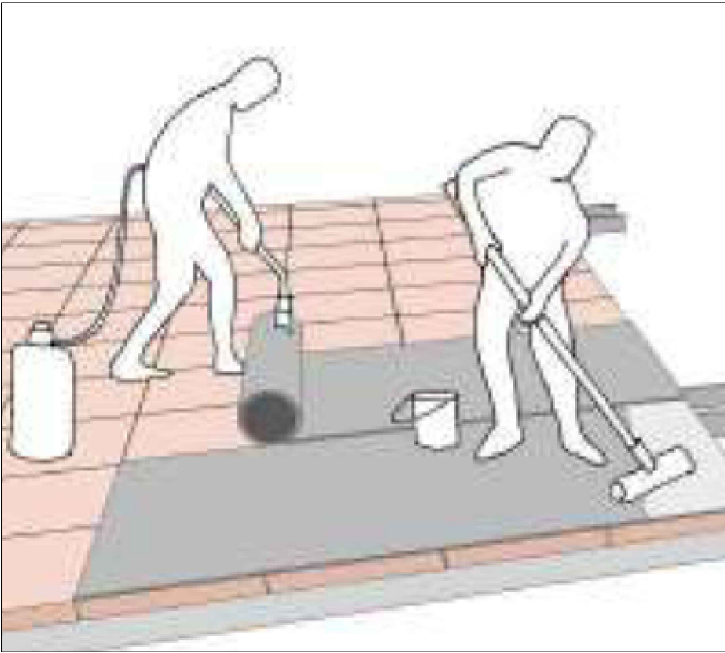
5. IMPRIMACIÓN CON ADITIVO
