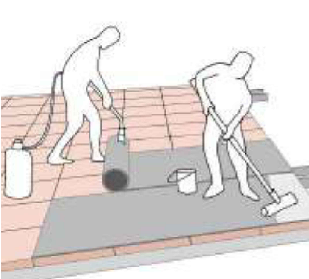
5. IMPRIMACIÓN CON ADITIVO
