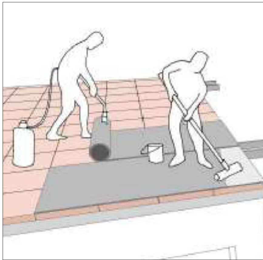
5. IMPRIMACIÓN CON ADITIVO
