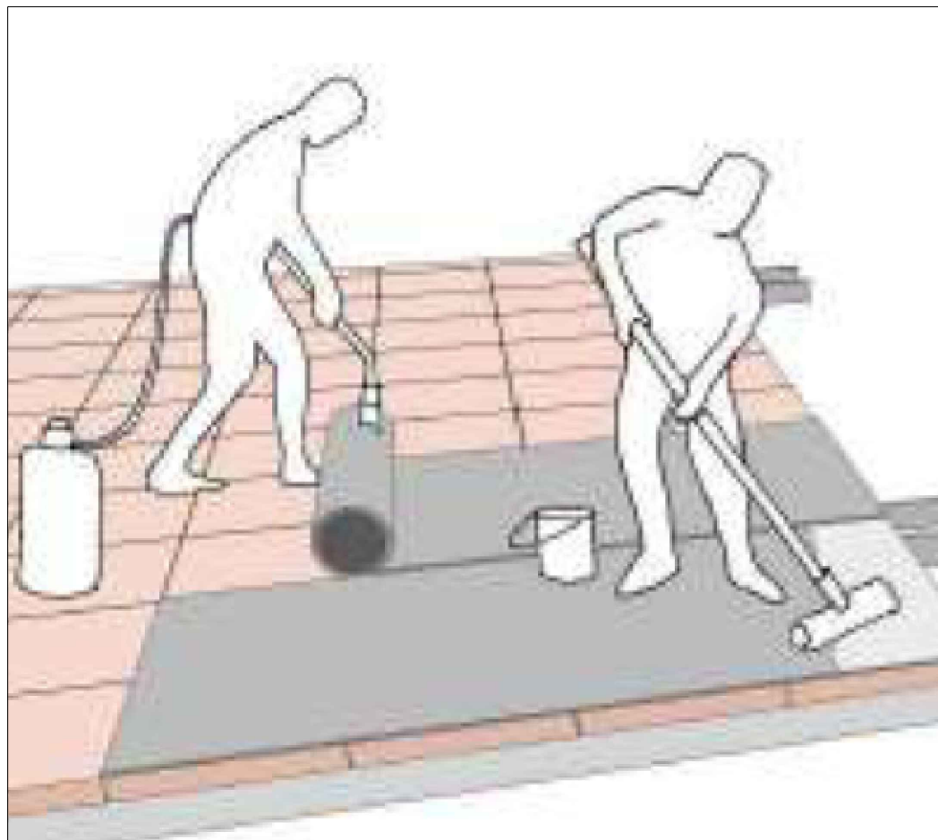
5. IMPRIMACIÓN CON ADITIVO
