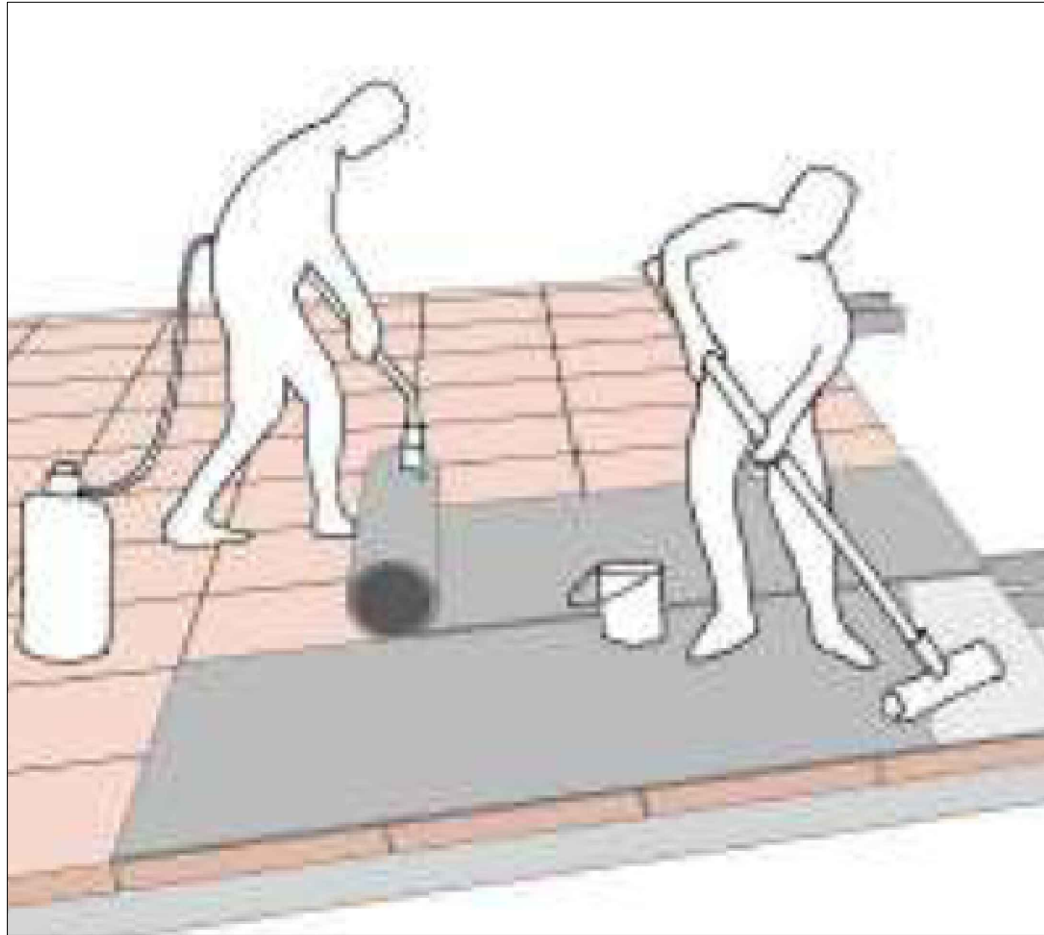
5. IMPRIMACIÓN CON ADITIVO
