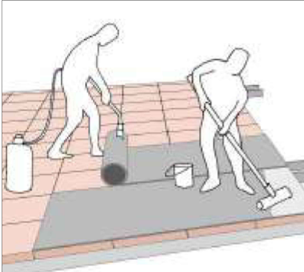
5. IMPRIMACIÓN CON ADITIVO
