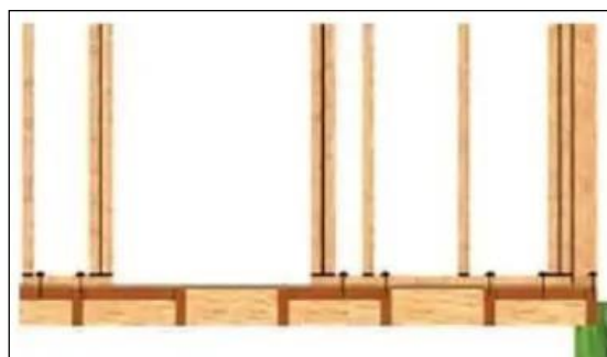
Imagen. Anclaje de tabique auto soportante a plataforma de madera por tirafondos
