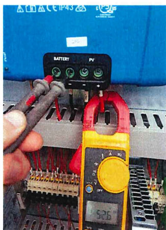
Foto N°17: Tensión de salida de regulador de carga- Baterías: 52.6 Vdc
