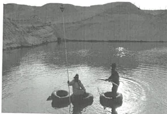
b) Levantamiento de fondo de poza de oxidación existente (Batimetría).
